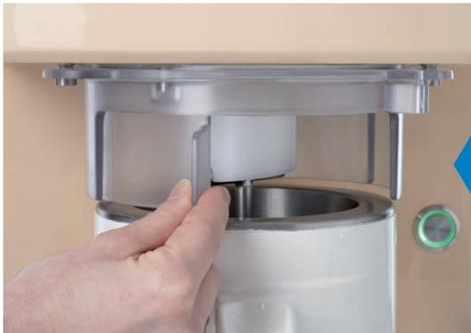
Sofortiger Stopp des Rührwerks beim Öffnen des **Schutzdeckels** während der Eiszubereitung.
