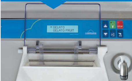
**Die Handbrause ist frontseitig an der Maschine angebracht**, wodurch ein größerer Komfort bei der Reinigung des Zylinders und der Eisabgabe erreicht und gleichzeitig die Behinderung durch den Frontverschluss vermieden wird. Die Handbrause hat zudem eine Blockierfunktion, die das Handling während des Gebrauchs erleichtert.
