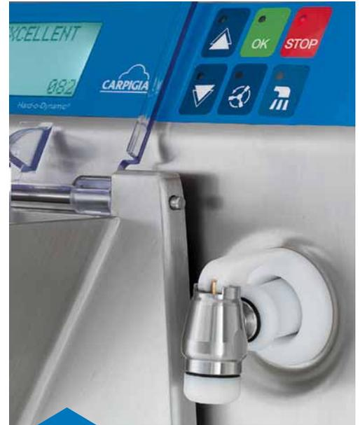
**Die Handbruse ist frontseitig an der Maschine angebracht**, wodurch ein größerer Komfort bei der Reinigung des Zylinders und der Eisausgabe erreicht und gleichzeitig die Behinderung durch den Frontverschluss vermieden wird. Die Handbruse hat zudem eine Blockierfunktion, die das Handling während des Gebrauchs erleichtert.
