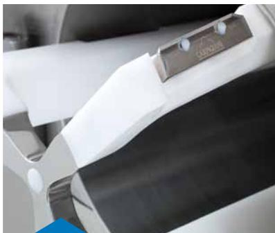
Das Carpigiani-Rührwerk aus POM ohne zentrale Welle, ermöglicht eine optimale Vermischung des Eismixes ohne Anhaften auf den Spateln. Die Eisausgabe erfolgt nahezu ohne Rückstände. Die selbstregulierenden Abstreifer (einfach herausnehmbar) gewährleisten ein exaktes Abschaben der Eisschicht auf dem Zylinder.
