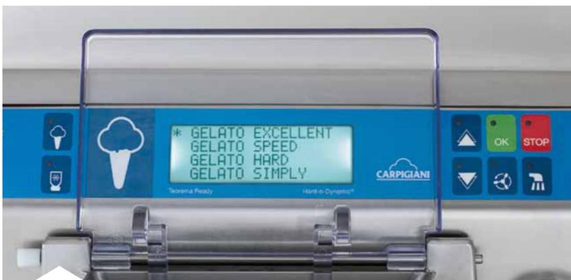
Die transparente Abdeckung des Einfülltrichters gestattet während des Einfüllvorgangs ein **freies Bedienen aller Funktionstasten**, da diese nicht verdeckt werden.
