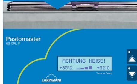
**Deckel und Display:** wenn die Temperatur 50° übersteigt, um die Spritzer der heißen Mischung zu vermeiden, stoppt der Rührwerk beim Deckel hochheben. Das Display warnt den Operator davor, ob es im Inneren der Maschine heiße Produkte gibt, um falsche Bewegungen zu vermeiden.
