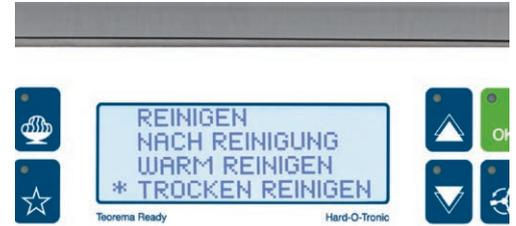
Nach Beendigung der Reinigung können mit dem **Trocknungsprogramm** alle **Feuchtigkeitsrückstände im Zylinder beseitigt werden**, was eine wesentliche Voraussetzung ist bevor man Schokolade Temperiert.
